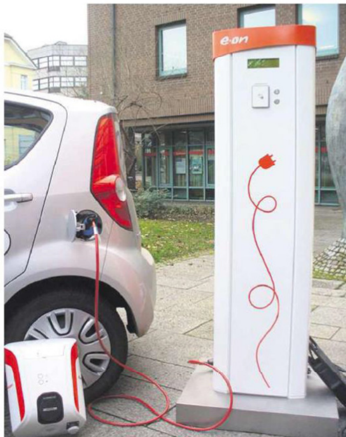
Strom für Autos: Ladestation für Garage und Ladesäule.
